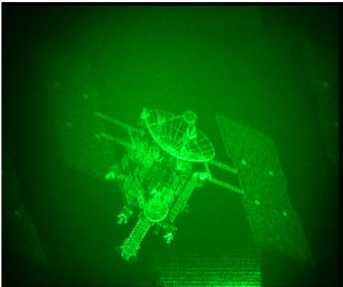
改良された「HORN-8システム」により投影されたより高画質なビデオホログラフィ再生像。
