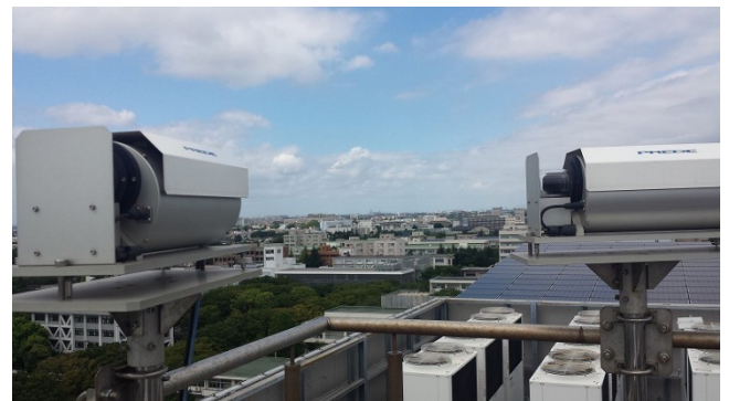
図 2 千葉大学西千葉キャンパス内で稼働中の MAX-DOAS 装置の外観。千葉市では 4 台の MAX-DOAS 装置をそれぞれ異なる方向に向けた同時観測を行い、精度を高める工夫を施した。
